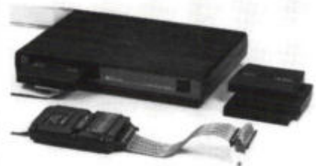
Afb. 3. Modulaire digitale meetsystemen Atlas en Colt (bovenste instrument), hier afgebeeld met een aantal inschuifmodulen.
