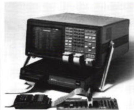
Afb. 1. De zelfstandige Micro Trace-eenheid MT80 is bruikbaar in combinatie met zowel de Dolch logica-analysator 64300 als, zoals in deze afbeelding, met de Palas.
