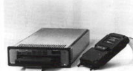
Afb. 4. Micro Trace-cassette 9608 voor toepassing in Atlas- of Colt-systeem.
